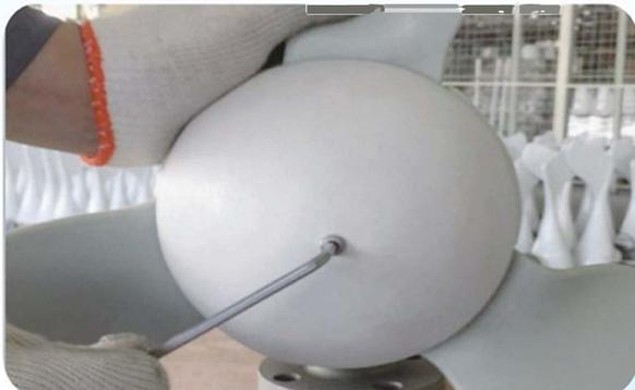
5, conecte el domo al cubo de las palas. Sentirás que encaja en su lugar. Instale la cúpula con un perno hexagonal en el eje, atornille el perno. Tire del domo para asegurarse de que esté seguro.
