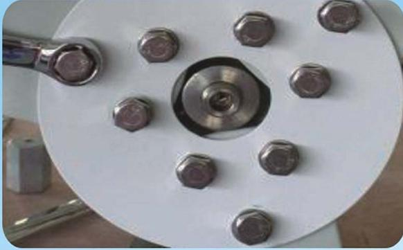
1, Monte la placa del hub y las palas en el cubo de la cuchilla, atornille la tuerca de seguridad. (Ver imagen superior).
