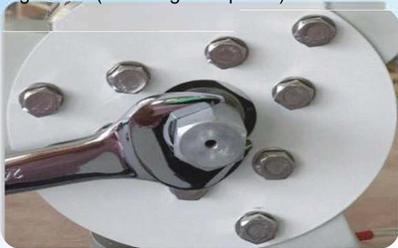
3, Instale la tuerca hexagonal en el centro del eje del rotor y atornille la tuerca de seguridad.
